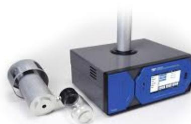
Fig. 7. Monitor de material particulado fino (PM2.5) Teledyne T640
