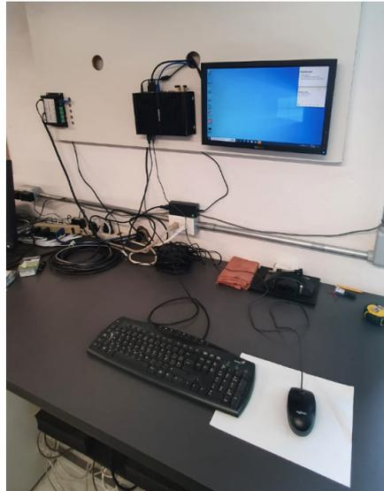
Figura 1. Tablero de control para la automatización de procesos dentro del contenedor. En esta fotografía aún no se muestra la fuente de poder y el adquisidor de parámetros internos del contenedor para vigilar la operación de todos los equipos de manera remota.
