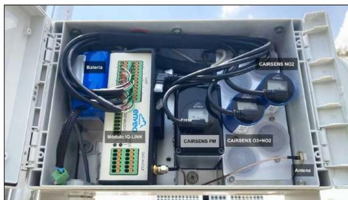
**Figura A1-3.** Distribución de los componentes internos en uno de los dispositivos CAIRNET en evaluación.
