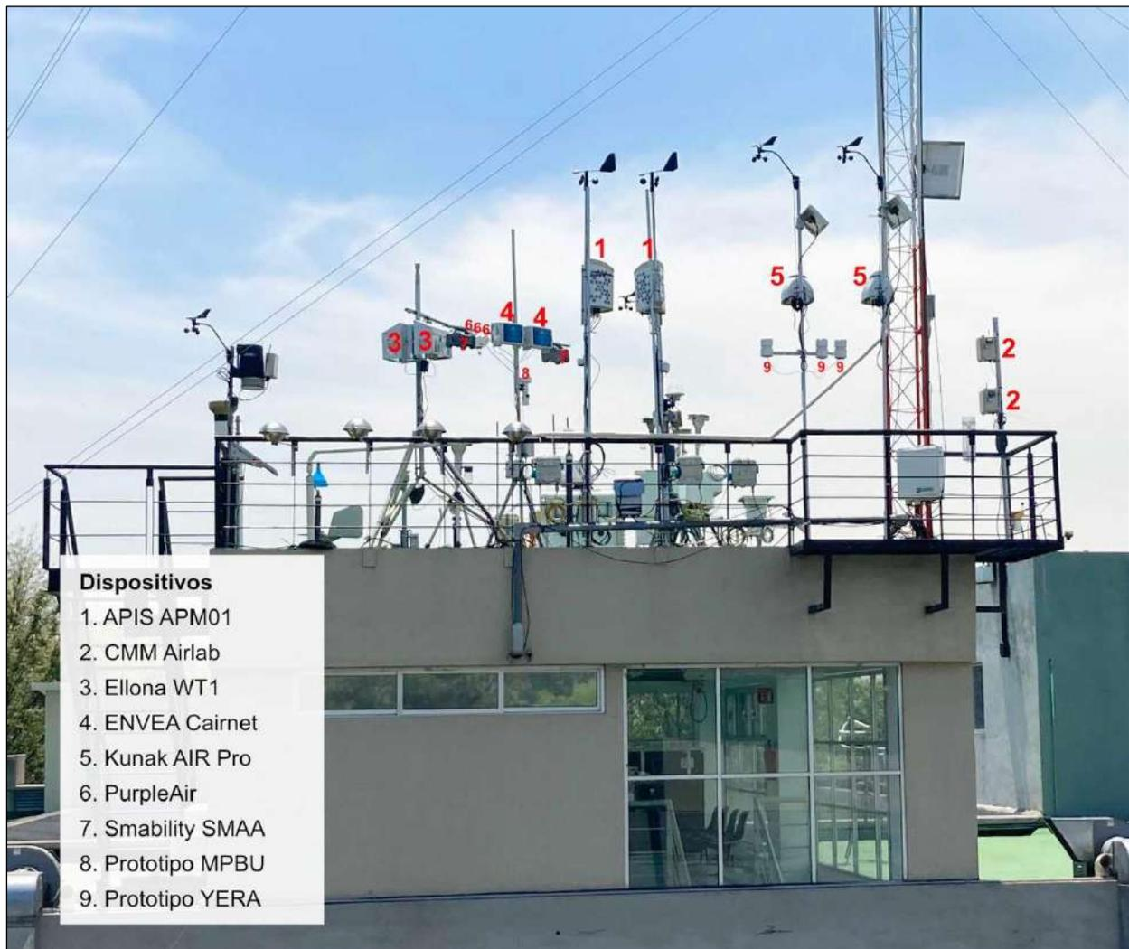
**Figura 3.** Despliegue de los dispositivos en el Instituto de Ciencias de la Atmósfera y Cambio Climático (ICAyCC) al sur de la ciudad.
