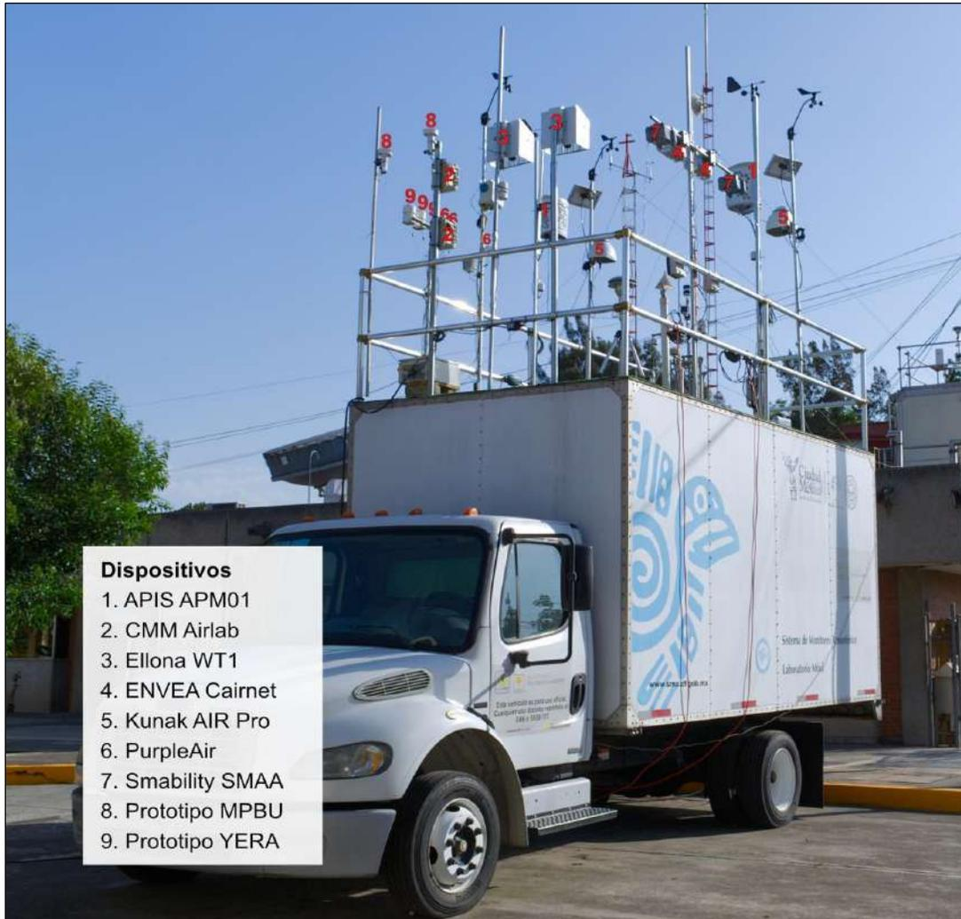
**Figura 2.** Despliegue de los dispositivos en el Laboratorio de Análisis Ambiental (LAA) al norte de la ciudad.
