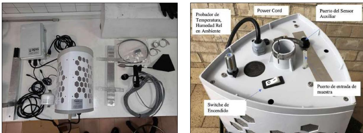
**Figura A1-4.** IZQ: Componentes de la estación de monitoreo APIS. DER: Vista de la sección inferior del dispositivo (imagen: manual del usuario).
