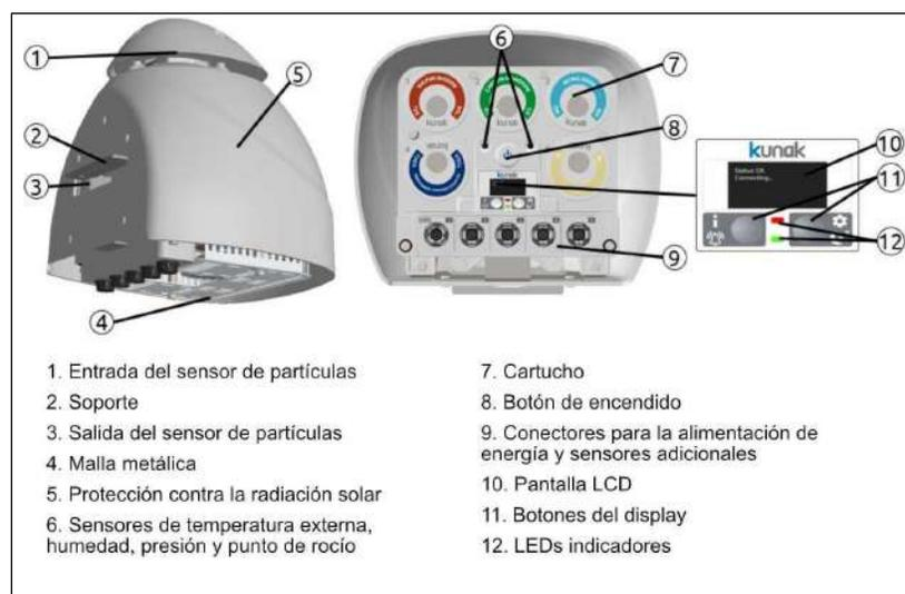
**Figura A1-6** Componentes de la estación Kunak AIR Pro (imagen tomada del Manual del Usuario)
