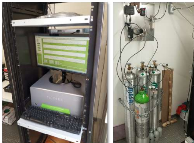
Fig. 5.5 Izquierda: Espectrómetro de extinción anular en cavidad (CRDS) marca Picarro, modelo G2401. Derecha: sistema de válvula y cilindros de calibración y seguimiento.
