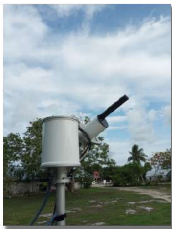
Figura 5.4. Fotorradiómetro Pandora instalado sobre el Observatorio Atmosférico Calakmul para medir columnas verticales de \text{NO}_2 , \text{O}_3 y \text{HCHO} .
