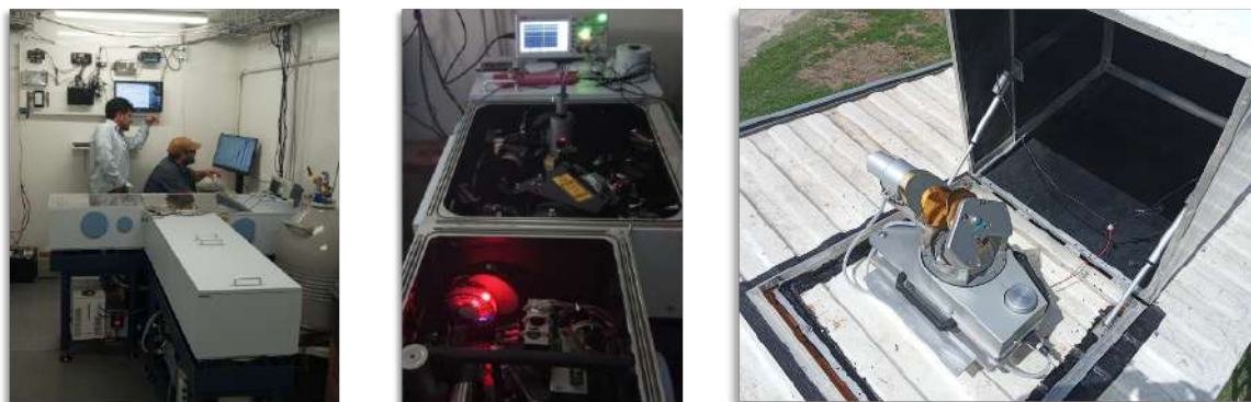
Figura 5.2. Interferómetro Bruker IFS 125HR instalado en el contenedor para medir espectros solares de alta resolución en el rango IR cercano. A la derecha se visualiza el sistema óptico para el seguimiento autónomo del movimiento solar.
